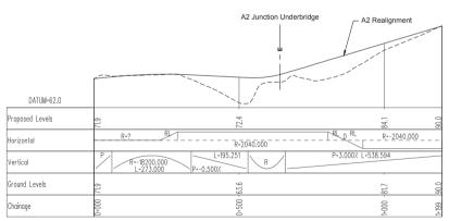
A2 REALIGNMENT PROFILE H:V SCALE 1:5000 - 1:500
